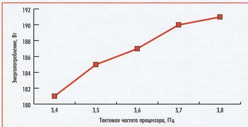
Зависимость энергопотребления системы от тактовой частоты работы процессора при его полной загрузке
